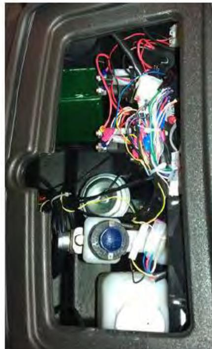
Figura 5.4 – Alloggiamento del GEB nel veicolo Estrima Birò
