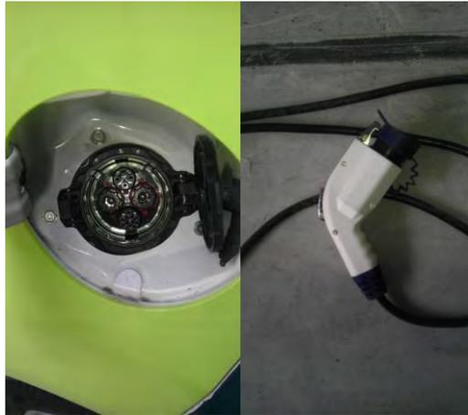
Figura 3.31 – Cavo di ricarica (destra) e presa lato veicolo (sinistra) Citroën CO
