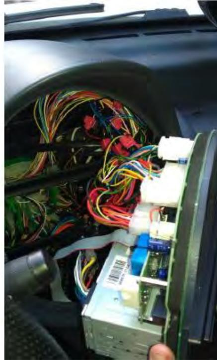
Figura 5.3 – Alloggiamento del GEB nel veicolo Tazzari Zero
