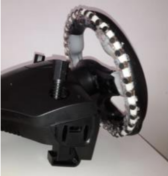
Attuatori distribuiti lungo il volante
